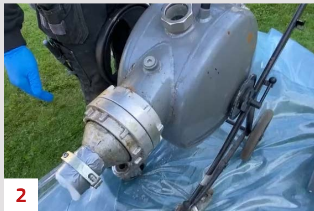
2 Filtstrømper produseres på mål etter rørene, og føres inn på en trykktank, eller "kule".
